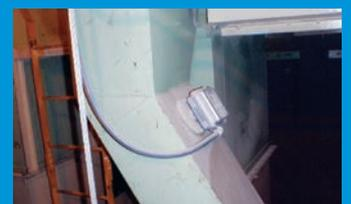
Auto-Set™ Flachsonde am Auslauf eines Bandförderers installiert
