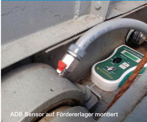
ADB Sensor auf Fördererlager montiert
