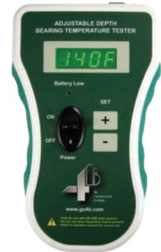
Das ADB Lagertempersensoren- Prüfgerät wurde für die Überprüfung tiefenjustierbarer 4B Lagertempersensoren (ADB) in der Praxis entwickelt. Die Einheit heizt den Sensor über integrierte Steuerungen und bei angezeigter Temperatur bis zu dem gewünschten Auslösepunkt auf und ermöglicht so ein einfaches Überprüfen des Sensor- und Temperaturüberwachungssystems in Echtzeit.
