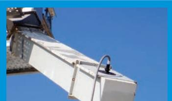
Binswitch installiert an Elevatorauslauf (mit SMP, BAS & Isolierrohradapter)
