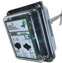
Ein Drehflügelmelder zum Erkennen hoher/niedriger Mengen von Schüttgut in Behältern, Tanks und Silos. Er kann auch als Verstopfungssensor in Förderschächten verwendet werden, wo eine lange Lebensdauer und eine ausfallsichere Erkennung erforderlich sind. Der **RLI „Shaker“** dreht sich im Uhrzeigersinn, dann entgegen dem Uhrzeigersinn und schüttelt sich, um überschüssigen Materialaufbau zu vermeiden.
