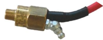
Die Baureihe **WDB8** ist eine Auswahl an Lager-temperatursensoren zum direkten Einschrauben in einen vorhandenen 1/4 Zoll BSP-Schmiernippel auf dem Lagergehäuse. Jeder Sensor ist mit einem Schmiernippel versehen, über den das Lager ohne Ausbau des Sensors geschmiert wird. Die WDB-Serie ist entweder mit einem PTC-Thermistor mit verschiedenen werkseitig eingestellten Auslösepunkten oder einem NTC-Thermistor mit einem benutzer-einstellbaren Auslösepunkt verfügbar.
