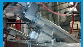
Auto-Set™ Flachsonde am Auslauf eines Schraubenförderers installiert
