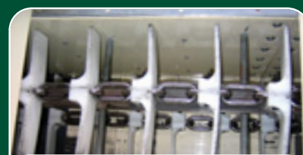
Système Bolt 'n' Go avec des maillons de chaîne en fil Application dans un convoyeur
