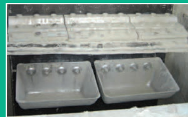
Braime Klemme auf 4B Stahlgewebegurt
