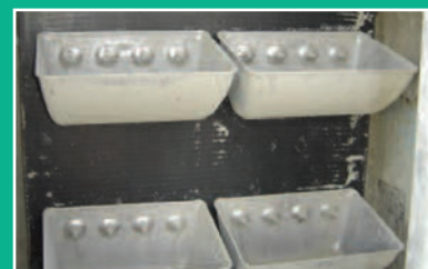
Starco Jumbo- Becher auf 4B Stahlgewebegurt in der Zementindustrie
