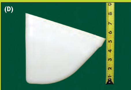
(D) With the elevator bucket back held vertical, measure height to front lip (D). วางแผ่นหลังของกะพ้อในแนวตั้งและวัดความสูงถึงปากกะพ้อ
