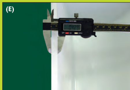
(E) Using a micrometer, measure the thickness of the steel bucket. Use a micrometer or ruler for plastic buckets. วัดความหนาของกะพ้อเหล็กด้วยไมโครมิเตอร์และวัดความหนาของกะพ้อพลาสติกด้วยไมโครมิเตอร์หรือไม้บรรทัด
