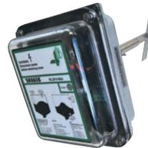
Un interruptor por paleta giratoria se utiliza para detectar niveles altos / bajos de material sólido granular en recipientes, contenedores y silos. También se puede usar como sensor de bloqueos en conductos, donde la detección para la protección contra fallos y la larga duración son esenciales. El **RLI "Shaker"** gira primero en sentido horario y luego en sentido antihorario, para finalmente vibrar y eliminar cualquier exceso de material que se esté acumulando.
