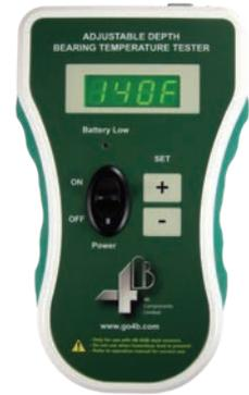
El tester de sensores ADB se ha diseñado para probar sobre el terreno los sensores de temperatura del cojinete del tipo sonda de profundidad ajustable (ADB) de 4B. La unidad dispone de un sistema de control integral y visualización de temperatura y funciona calentando el sensor hasta el punto de activación deseado, lo que permite una comprobación rápida, real y sencilla del sensor y del sistema de supervisión de la temperatura.
