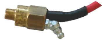
La serie **WDB8** es una gama de sensores de temperatura de cojinetes diseñados para atornillar directamente a un engrasador BSP de 1/4" existente en una caja de cojinetes. Cada sensor está equipado con una boquilla de engrase para permitir la lubricación del cojinete sin necesidad de retirar el sensor. La serie WDB está disponible o bien con un termistor PTC con varios puntos de activación ajustados en fábrica o con un termistor NTC con un punto de activación ajustable por el usuario.
