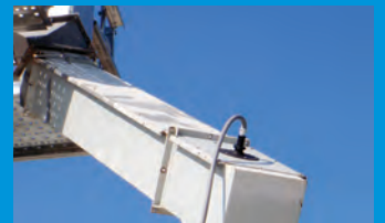
Binswitch 安装在下料溜槽上监测堵料
