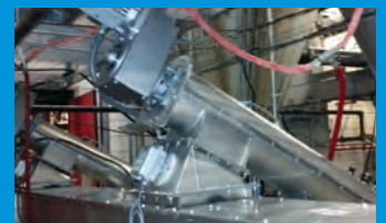
Auto-Set™ 紧凑型安装在螺旋输送机下料口监测堵料情况
