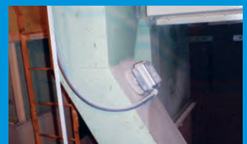
Auto-Set™ F紧凑型安装在皮带输送机下料口监测堵料情况
