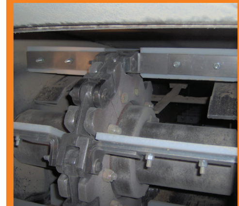
UHMW超分子量叶片衬板安装在采用T形金属叶片的装式链条系统上（输送机驱动端）
