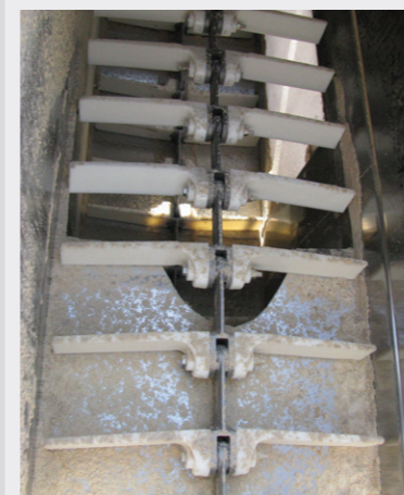
Bolt 'N' Go 组装式链条系统用在饲料厂
