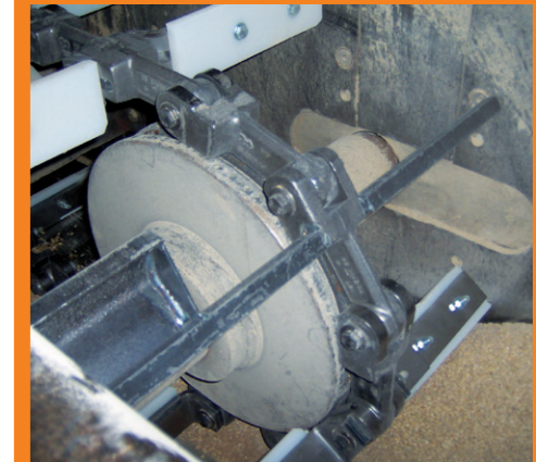
UHMW超分子量叶片衬板 & 返回料斗（输送机从动端）
