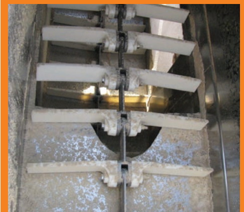
Aplicación en molino de piensos con la cadena Bolt 'N' Go con aletas de nylon
