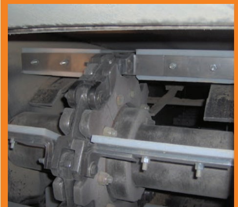
Paletas UHMW en placas en «T» – Extremo de la transmisión
