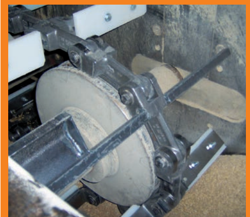
Paletas UHMW y cangilones de retorno – Extremo posterior
