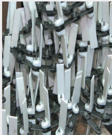
Cadena Bolt 'N' Go montada
