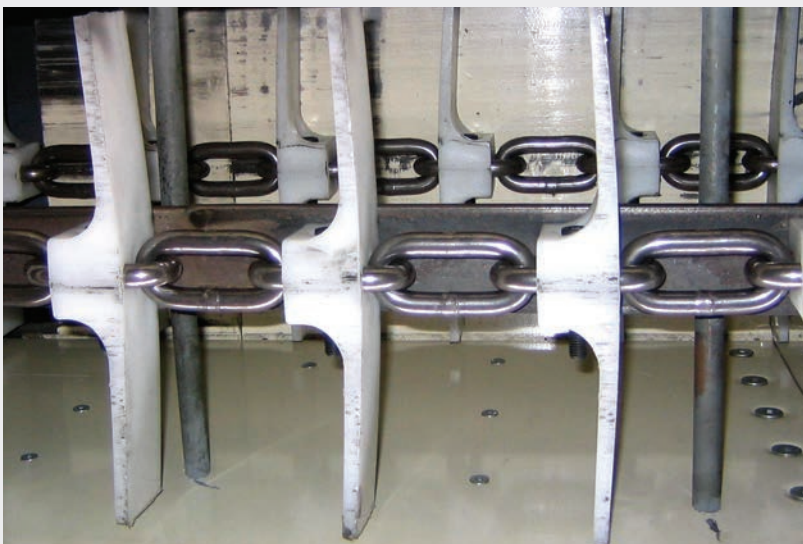
Aplicación de la cadena de eslabones redondos del sistema Bolt 'N' Go en un transportador
