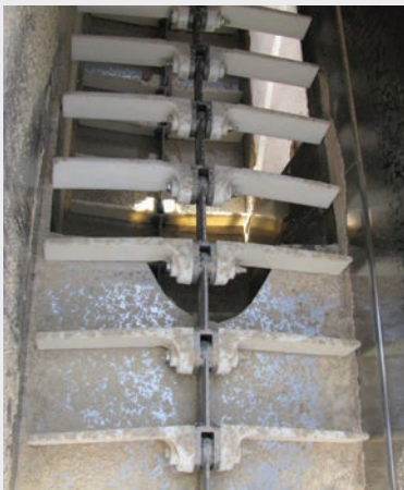
Aplicación en molino de piensos con la cadena Bolt 'N' Go con aletas de nylon
