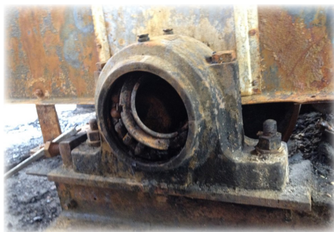
Изображение 2: Причина возгорания — неисправный подшипник
