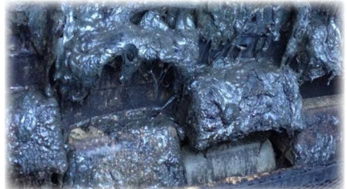
Figura 3: Tazze danneggiate dell'elevatore adiacente
