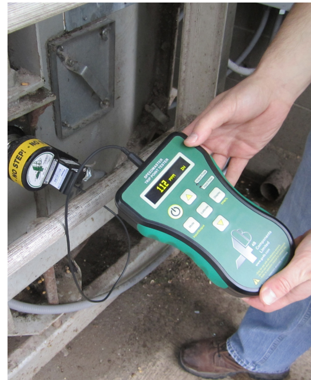
Dispositif de vérification des contrôleurs de rotation
