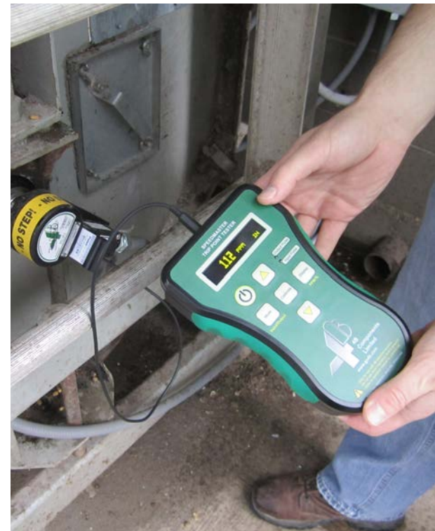
Speedmaster - Testgerät für Geschwindigkeitssensoren
