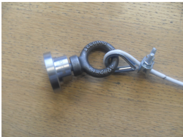
两端带有高磁性磁铁的钢制拉索
