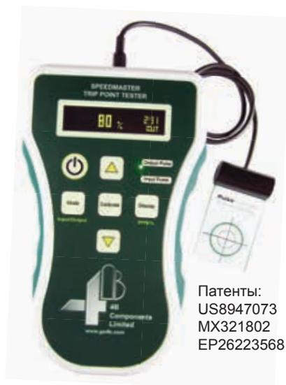
SpeedMaster™ с технологией Pulse Pilot представляет собой единственное средство для точной проверки калибровки индикатора скорости. Также устройство обеспечивает проверку функций тревожного сигнала и останова датчика при установке на валу машины.
