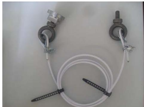
Pour la détection de déchirure, deux unités Bulldog sont nécessaires, une de chaque côté du convoyeur, le câble de déchirure de la courroie BRW relie les deux unités entre elles par des attaches magnétiques sur chaque Bulldog.
