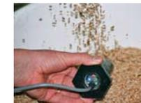
Si le capteur est utilisé en capteur de bourrage, faire couler le produit pour vérifier que la sensibilité n'est pas trop importante.
