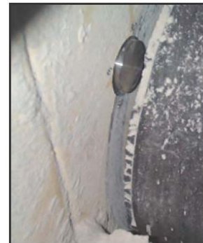
Touchswitch instalado da extremidade de um transportador de correia fechado (vista interna)
