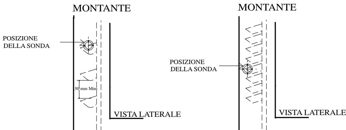
Vista laterale dell'elevatore che mostra la posizione delle sonde per allineamento della cinghia con uno scarto minimo tra le tazze di 50 mm.
