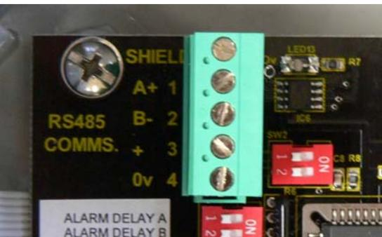
**-Bornes 1 et 2 ( A+ et B- )** sont utilisées pour le bus de terrain de type RS485 ( HOTBUS ). Un soin particulier doit être apporté afin que la connexion soit correcte sous peine d'avoir une perte de communication entre les 'nodes'
