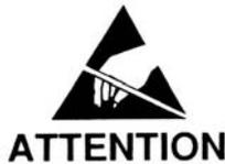
**Die Kontrolleinheit unterliegt elektrostatischer Aufladung. Zur Erzielung einer optimalen Leistung ist es erforderlich, die Anschlussklemme 31 sauber zu erden. Davor müssen Maßnahmen zum Schutz vor elektrischer Aufladung getroffen werden.**
