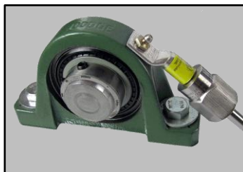
传感器安装在轴承座油嘴上的实例
