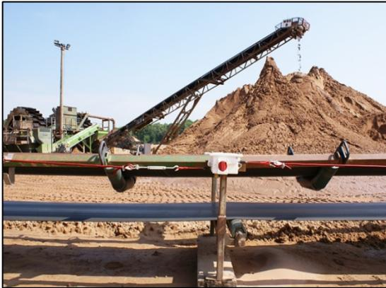
安装在露天采沙场开放式皮带输送机上的Pullswitch安全开关
