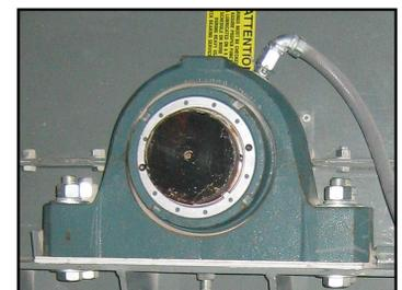
Датчик температуры подшипника ленточного конвейера
