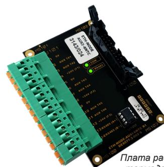
Плата расширения для термодатчиков NTC
