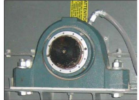
Sensor Instalado em Rolamento de Transportador de Correia
