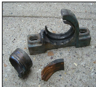
Esempio di cuscinetto danneggiato
