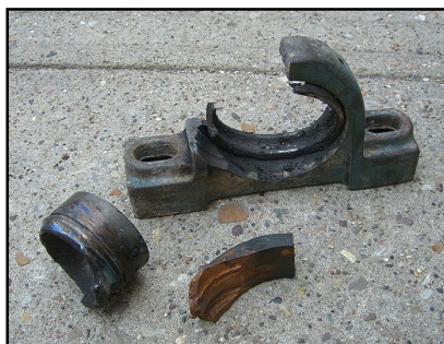
Esempio di cuscinetto danneggiato
