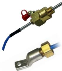
1. Thermistance NTC à graisseur incorporé, avec points de déclenchement réglables par l'utilisateur, se visse en lieu et place des graisseurs de palier. Les séries ADB sont équipées de sondes réglables en profondeur.
