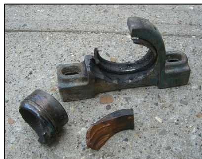
Exemple de défaillance du roulement
