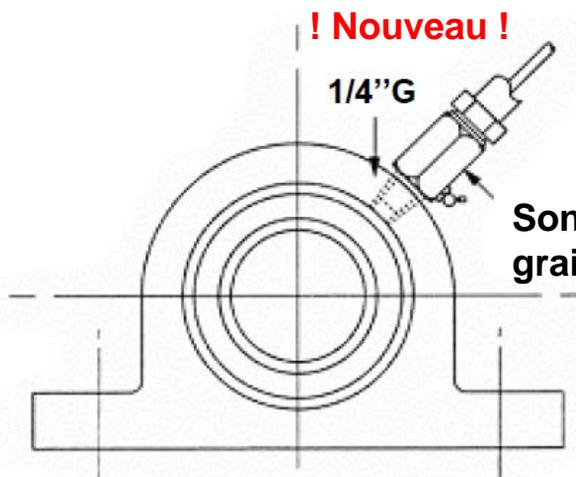
Montage d'un capteur sur un palier
