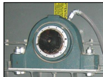
Capteur de roulement sur convoyeur à bande
