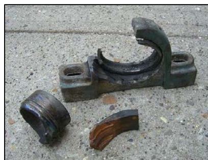
Exemple de défaillance du roulement
