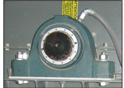
Sensor instalado en el cojinete del transportador
