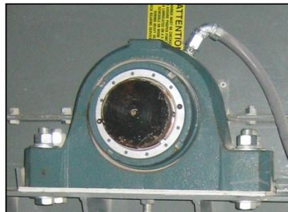
Sensor instalado en el cojinete del transportador
