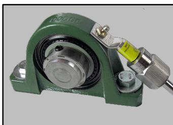
Montaje con orejeta sobre carcasa del cojinete
