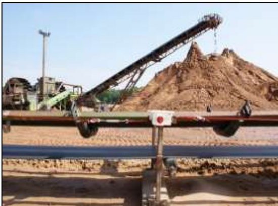
Pullswitch installiert am offenen Förderband in einer Sand- und Kiesgrube
