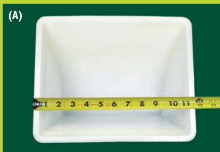
(A) With elevator bucket back laid flat, measure overall length (A). Con la espalda del cangilón plano, medir el largo completo (A).
