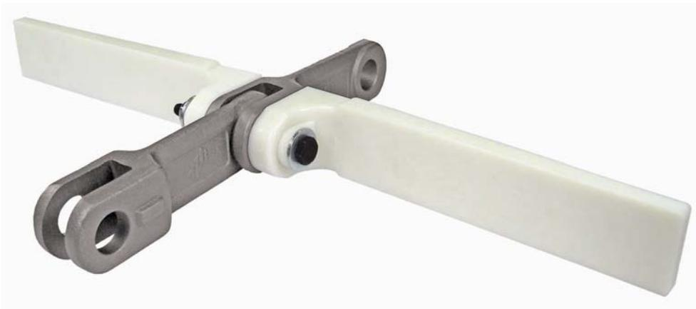
Anhand des Bolt 'n' Go Systems können Reparaturarbeiten, wie beispielsweise das Wechseln der Mitnehmer oder Bolzen innerhalb des Förderers vorgenommen werden, ohne dass die Kette dabei entspannt werden muss. Wir verwenden Bolzen an den Mitnehmern anstelle geschweißter Mitnehmer, und diese können wiederum ohne viel Aufhebens einfach gewechselt werden.
