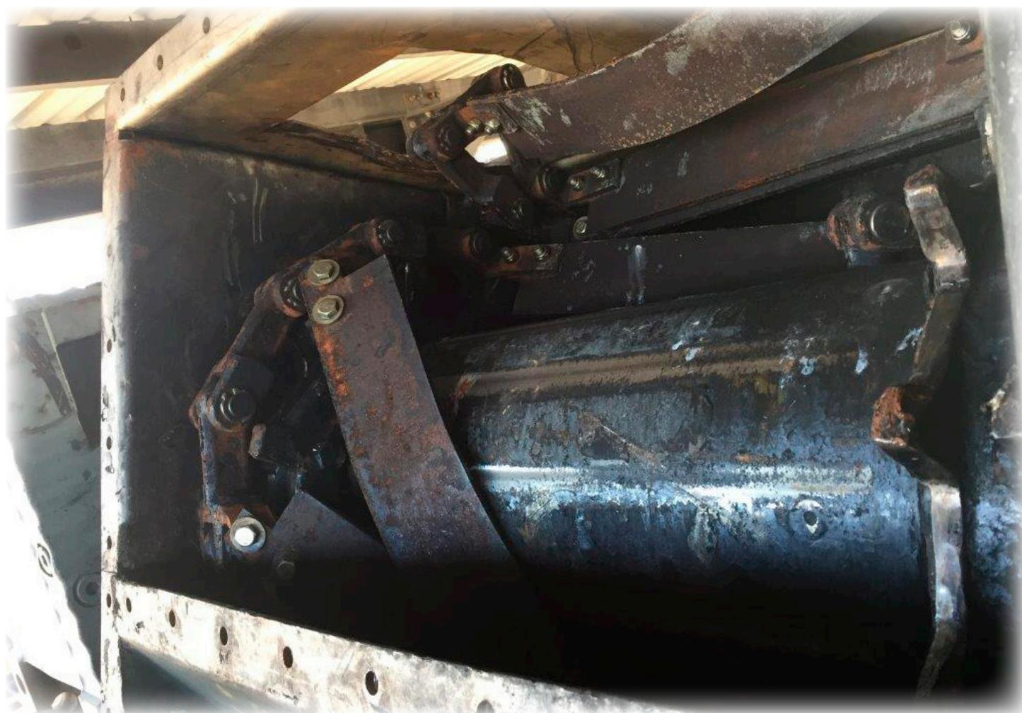
Наш заказчик столкнулся с проблемой малого срока службы цепей в цепных конвейерах. Цепные конвейеры транспортировали отходы нефтепереработки и очень быстро изнашивались. Основными причинами износа были коррозионность продукта и недостаточная прочность установленной цепи.
