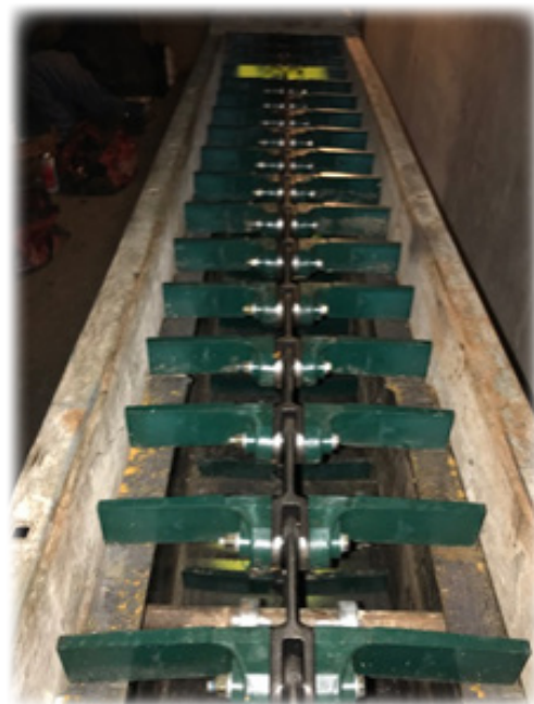
Лопатки из зеленого нейлона для системы цветовой сортировки
