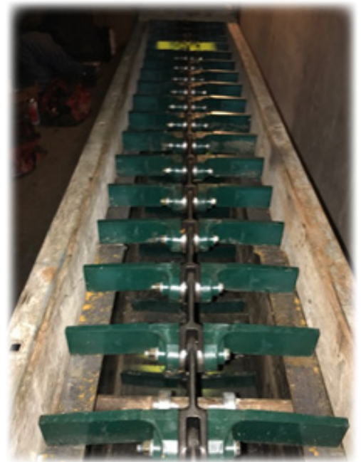
Pás de nylon verdes para classificador de cores
