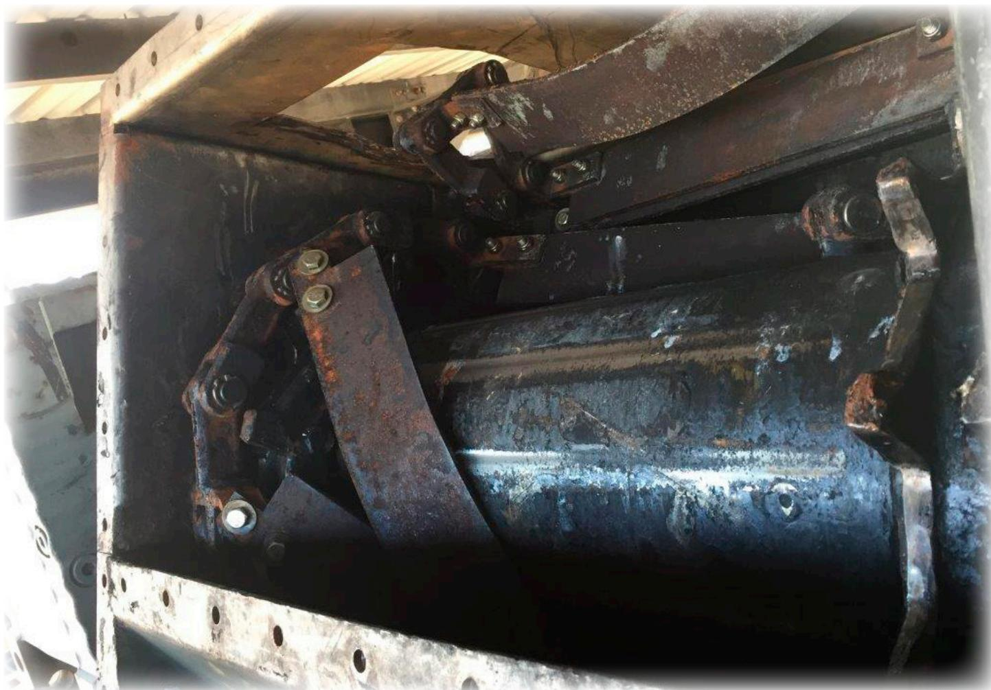
Il nostro cliente incontrava difficoltà con la durata della catena all'interno del trasportatore. I trasportatori a catena convogliavano un sottoprodotto della lavorazione del greggio e si usuravano con estrema rapidità. L'usura era principalmente dovuta alla natura corrosiva del prodotto e alla resistenza della catena installata.
