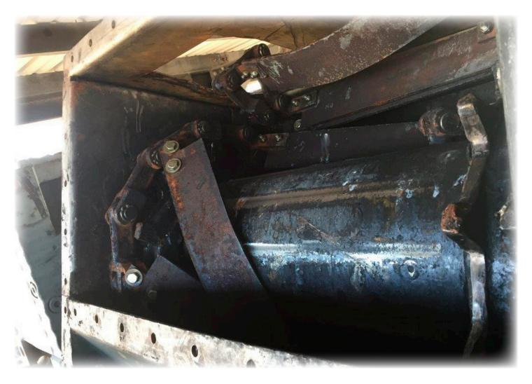
Nuestro cliente estaba experimentando problemas con la durabilidad de las cadenas de sus transportadores. Los transportadores de cadena se utilizaban para transportar un subproducto generado al procesar petroleo crudo, y se desgastaban a un ritmo muy acelerado. El desgaste se debía principalmente a la naturaleza corrosiva del producto y a la poca tenacidad de la cadena instalada.
