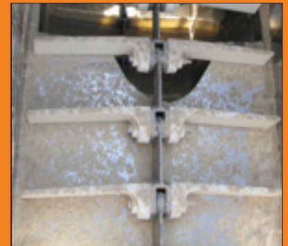
Futtermittel-Anwendung mit Bolt 'n' Go Kette inkl. Nylon-Mitnehmer
