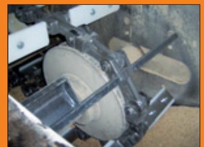
UHMW Paddel auf T-Mitnehmern - Foto Umlenkstation
