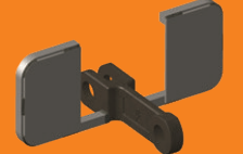
带挡料板的封闭式U型叶片
