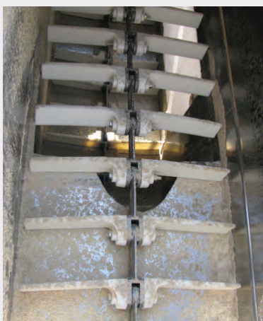
Применение в комбикормовой промышленности с использованием цепи Bolt 'N' Go с нейлоновыми скребками
