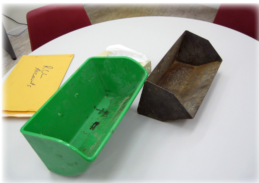
Imagem 2: Caçamba fabricada à moda antiga em aço e caçamba tipo CC
