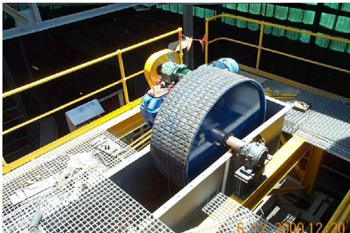
Die Antriebsstrommel am Kopf mit Reibbelag wird während der Gurt-Installation gezeigt.
