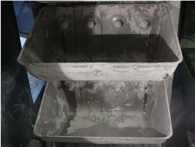
Das nächste Beispiel ist ein bestehender Kettenelevator in Australien, der von 120 t/h Zement auf 250 t/h aufgerüstet wurde mit einreihigen SJ470 Bechern und einem 4B Stahlgewebegurt SW1000 – 4+4. Der originale Elevator mit 25 m Hubhöhe war mit einer Kette ausgerüstet und es wurde entschieden einen 4B Stahlgewebegurt mit SJ-Bechern einzusetzen, um die Leistung und Standzeit zu erhöhen.
