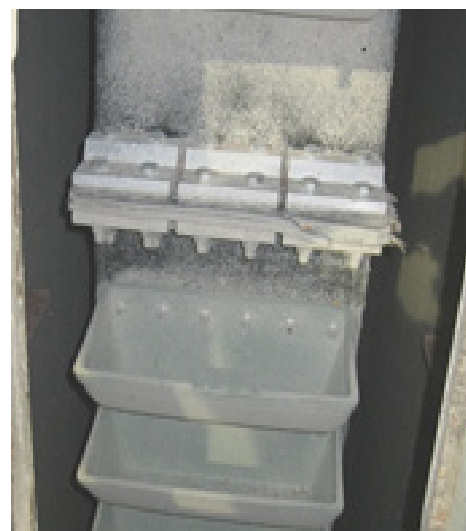
Godets 4B JUMBO™ CC-S® « low profile » 16x18, jonctions « 4B Braime Clamp » et sangles en caoutchouc de 179 kg/cm installés
