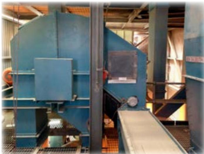
Imagen 4: Canaleta de descarga, después de las modificaciones
