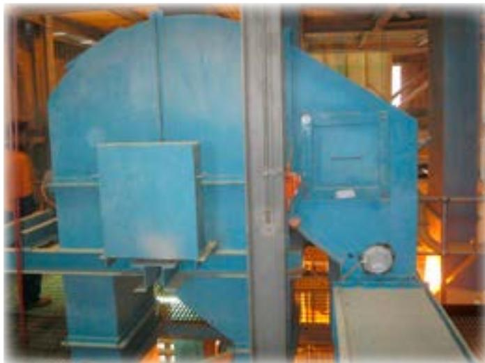
Imagen 3: Canaleta de descarga, antes de las modificaciones.
