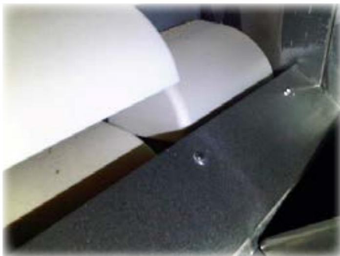
Imagen 5: Cangilones SPS instalados
